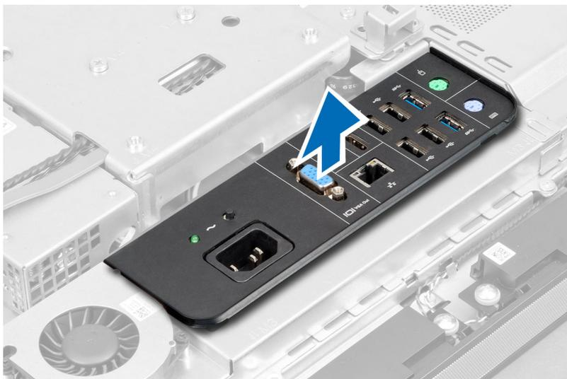
4. Выверните винты, которыми разъем питания крепится к экрану панели ввода-вывода.
