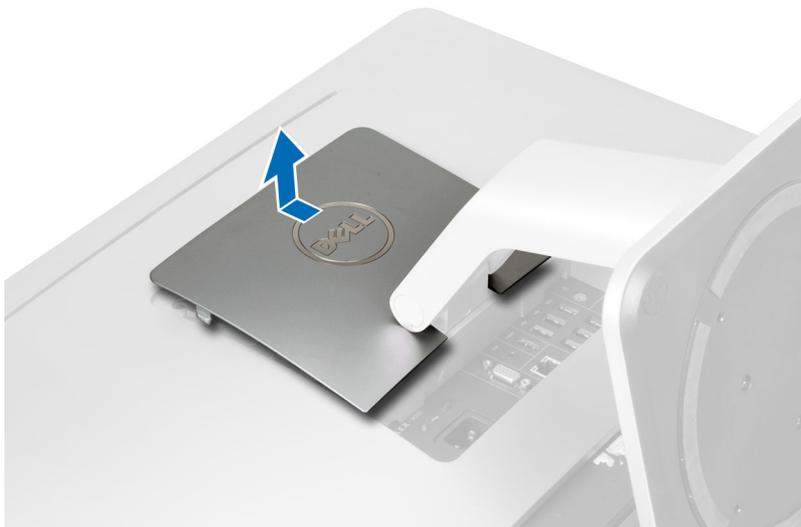
5. Выверните винты, которыми стойка VESA крепится к компьютеру, а затем снимите стойку VESA с компьютера.
