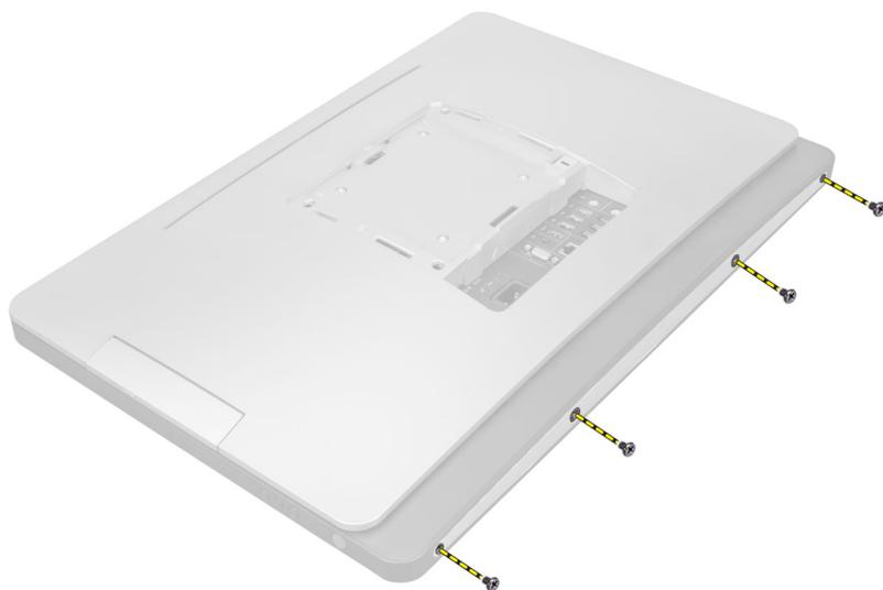
4. Приподнимите крышку и снимите ее с компьютера с помощью выемок, расположенных рядом с панелью ввода-вывода.
