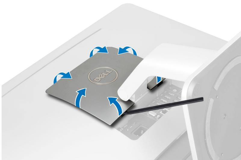
4. Приподнимите крышку VESA и снимите с компьютера.
